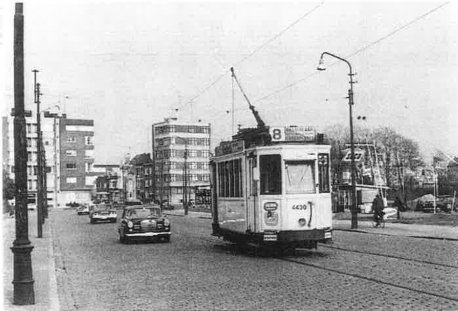
Foto 10: In mei 1966 zien wij de 4430 (ex-430) op lijn 8 (rood/geel) aan de "vestinggordel", nog vóór het begin van de "Ring"-werkzaamheden. De wagenbak is van de 182 afkomstig en heeft nog geen verdere verbouwing ondergaan. Toen was zelfs de trolley-stang nog aanwezig.
